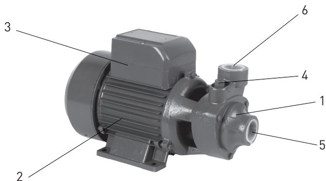
Насос состоит из следующих основных узлов: вихревого насоса (1), асинхронного электродвигателя (2) и пускового устройства (3). Насос имеет заливное (4), входное (5) и выходное (6) отверстия.
